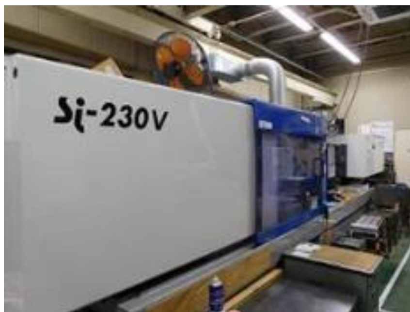
図 2.1.2.1-4 230 t 射出成型機 プラスター Si-230V（東洋機械金属株式会社製）
