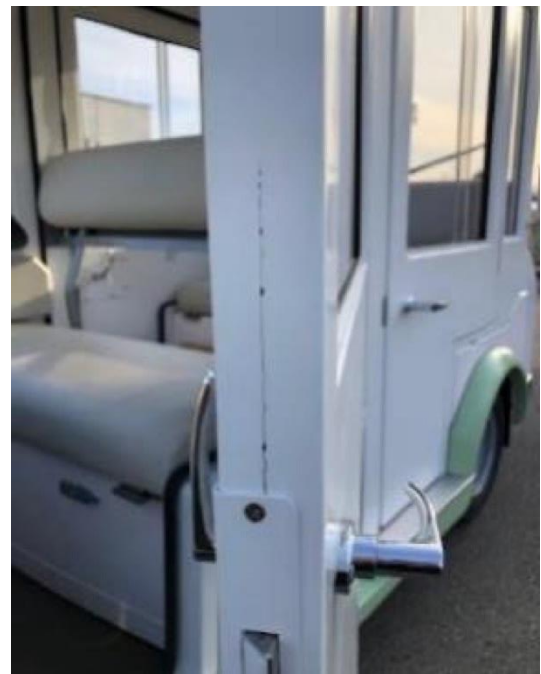
図 2.3.4-12 ドアの割れ確認 (2月25日)
