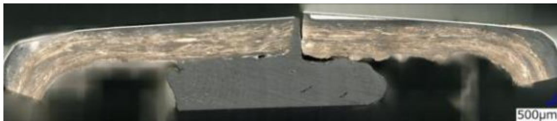
図 2.2.3-6 割れの見られたドアパネル接合部
