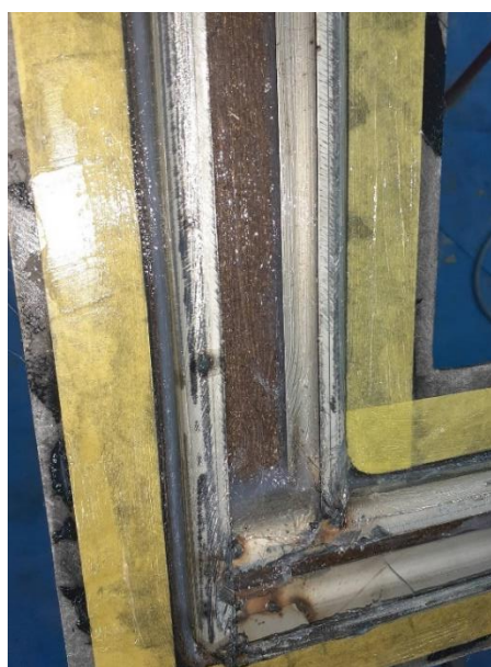
図 2.1.1.2-4 CNF パネルと鋼製枠接着
