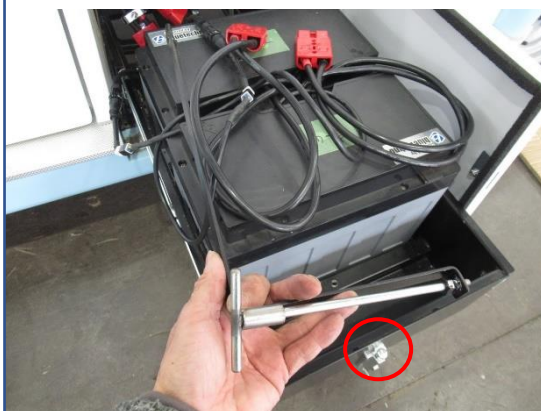
電池の固定ボルト（手で操作可能） 電池トレー解除ロック（赤丸）
