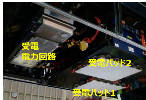
中型EVバス底部に搭載した受電装置
