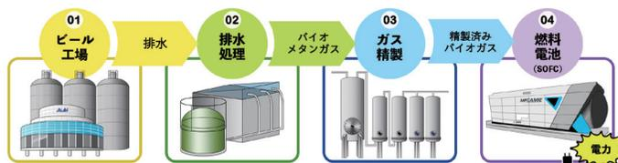
ビール工場排水由来のバイオメタンガスを利用したSOFCによる発電工程
