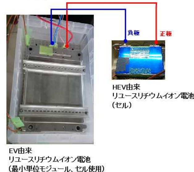
図8 短周期変動における電力損失を評価するためのHEV由来およびEV由来リユースリチウムイオン電池の並列組電池
