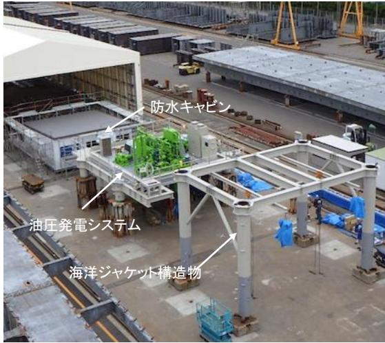
平塚波力発電所 (45kW) (Wave Rudder式) の構造と発電状況
