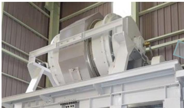
大型MA(メカニカルアロイング)製造設備
