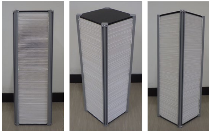
試作したキチンナノファイバ仕切板(左上図)と、仕切板と間隔板を組み合わせたロール(右上図) および本ロールを積層して試作する全熱交換器(下図)の外観写真
