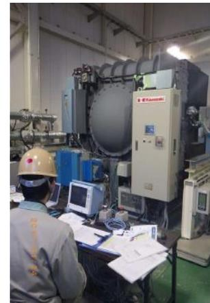
水冷媒ヒートポンプ単体試験の様況
