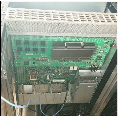
図(5-3) データセンタ用スイッチの冷媒滴下冷却実験
