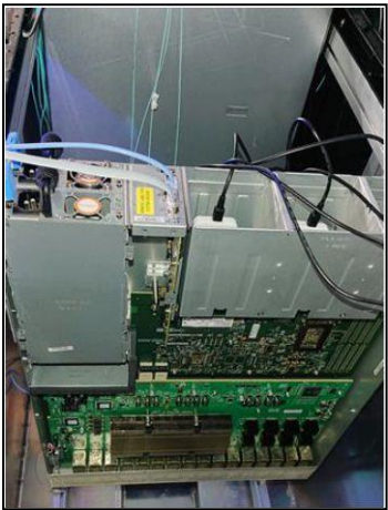
図(5-3) データセンタ用スイッチの冷媒滴下冷却実験
