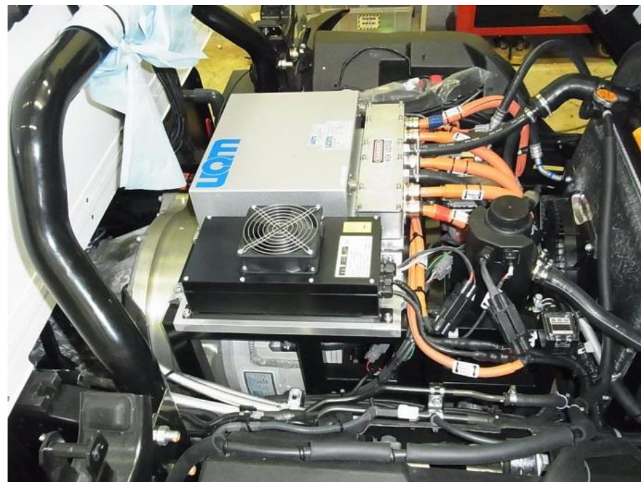
改造後エンジンルーム
