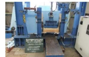
障子材仕口せん断強度性能試験 試験状況
