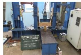
障子材仕口引張り強度性能試験 試験状況
