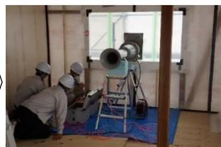
気密工事完了時/気密試験
