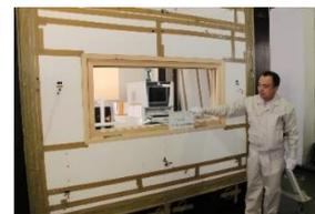
枠材・障子材断熱性能(Uf) 試験試験状況
