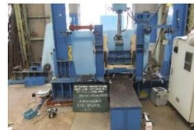
枠材材仕口引張り強度性能試験 試験状況
