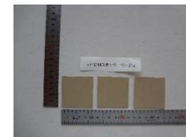
気密材の熱伝導率試験 試験体
