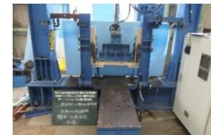
枠材材仕口せん断強度性能試験 試験状況
