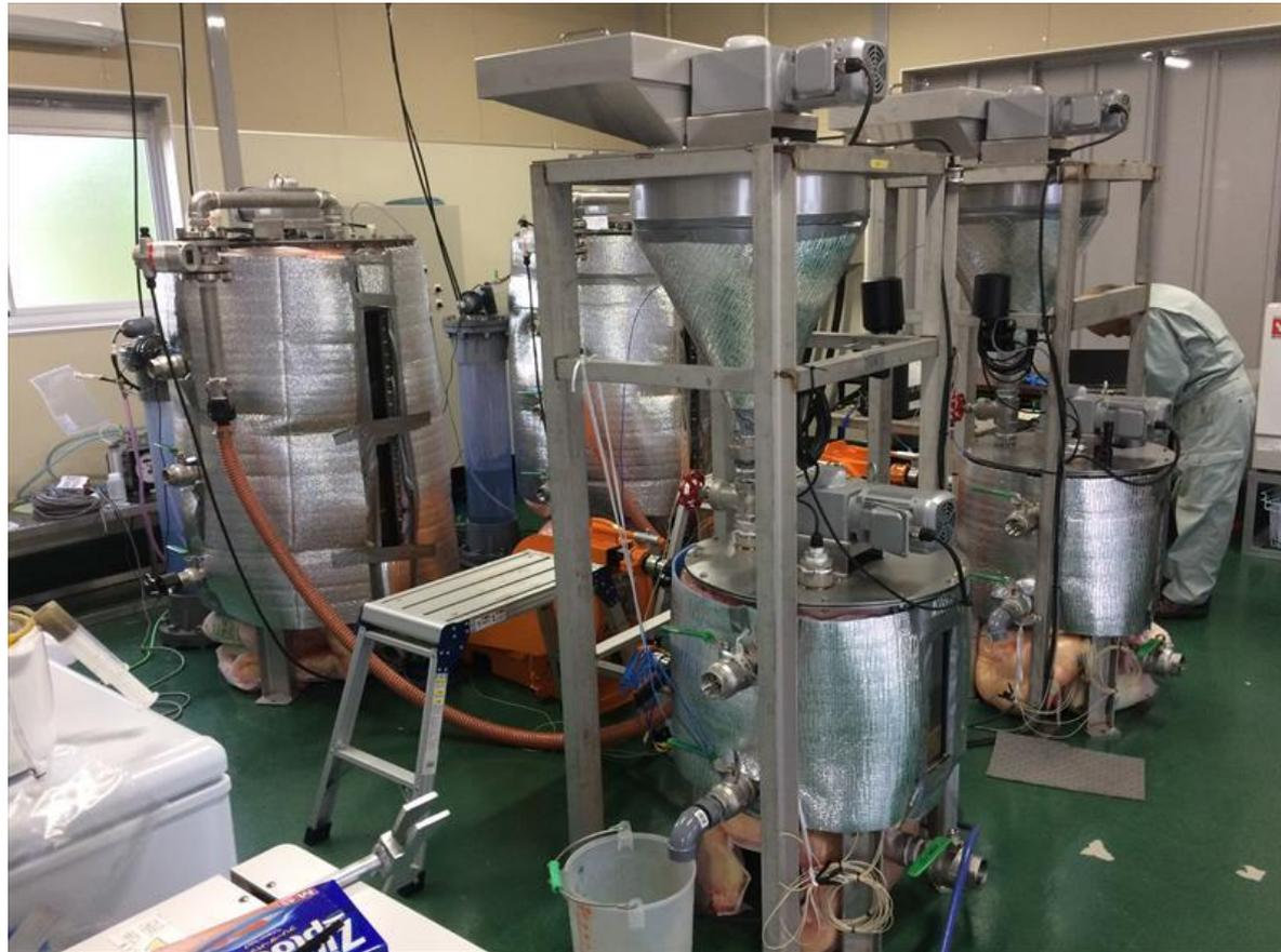
図 製作した実証機（発酵槽：400L）
