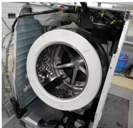
図4-3-5(2) CNF複合樹脂バルンサーを組み込んだ状態
