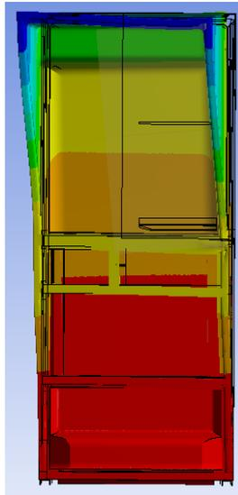
図4-2-3(14) 解析結果／冷蔵庫筐体の変形図
