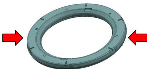
図4-3-2(2) バランサーの剛性評価時の負荷力方向
