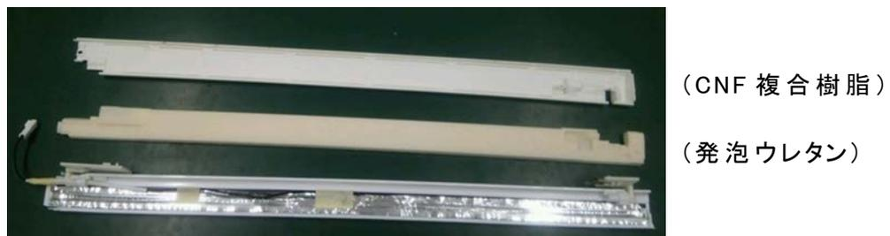
図4-2-5(1) センターピラー試作品の部材
