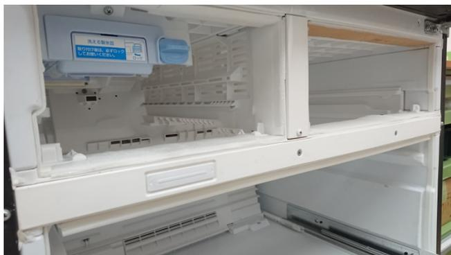
図4-2-5(4) CNF複合樹脂クロスレール試作品を組み込んだ冷蔵庫
