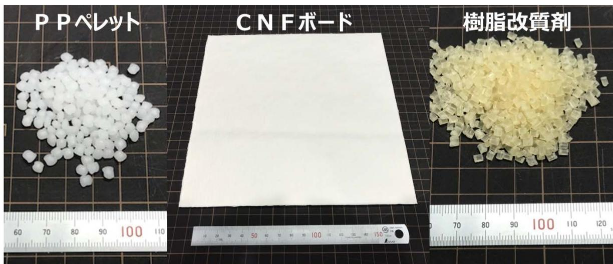
図4-4-3(5) CNF複合樹脂における各材料(測定サンプル)
