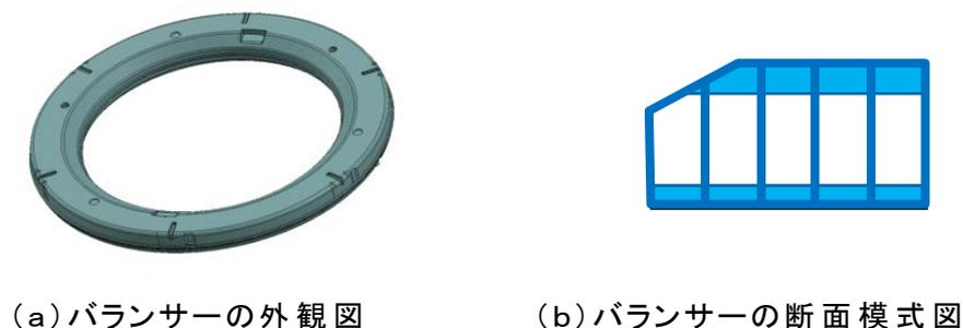
図4-3-1(2) バルンサーの外観図と断面模式図
