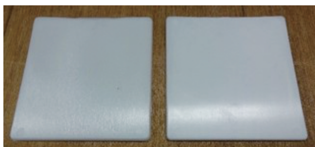
図 2.1-1 PA6 コアバック 2 倍発泡体の外観 (左：改善前，右：改善後)
