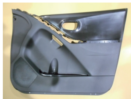
図 4.2-1. 実機で射出成形したドアトリム (CNF 配合率 10wt%)
