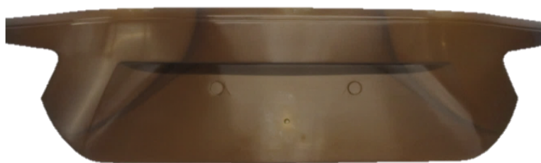
図 2.2-9 PA6-CNF5% MuCell 発泡成形品 トランクリッドロー
