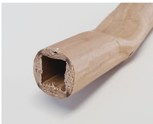
図 3.4-2 熱硬化後のパイプ膨れ
