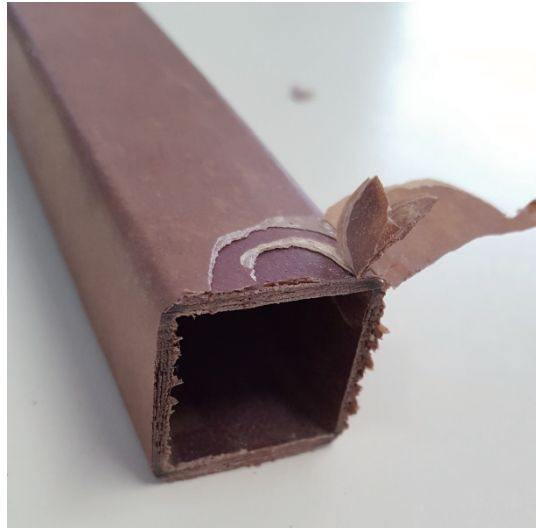
図 1.3-1 角パイプの層間剥離
