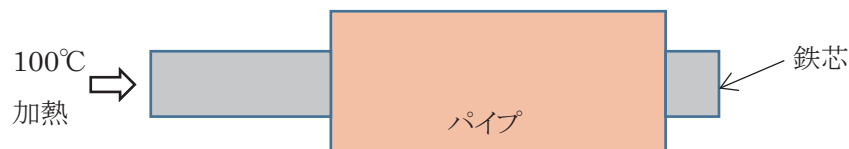
図 1.3-2 パイプの乾燥（内側から外側へ）
