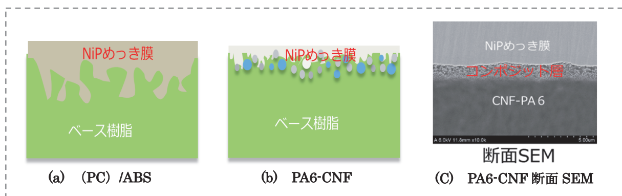
図 2.7-5 めっき / 樹脂界面の模式図、SEM 像
