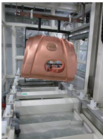
(a) 200L ラインでのめっき試作 （電解銅めっき後）
