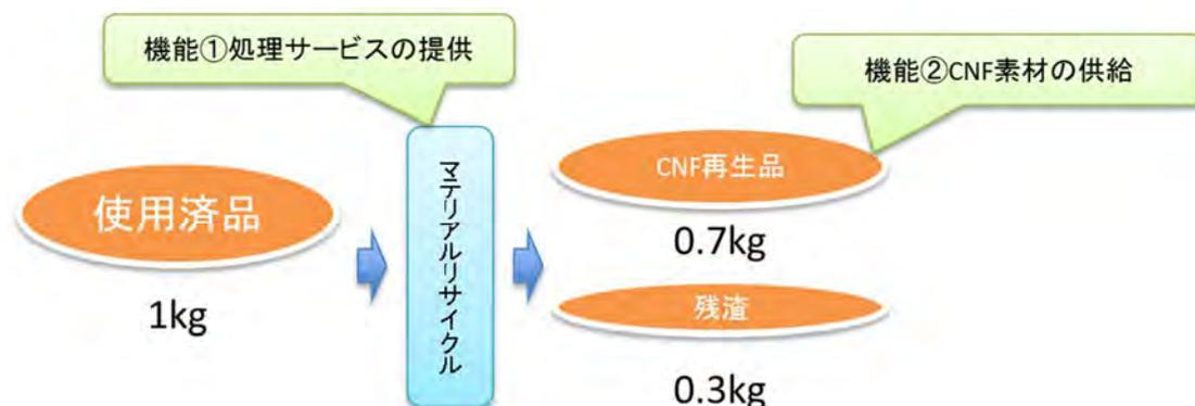
図 3-8 使用済 CNF 部材のマテリアルリサイクルの例
