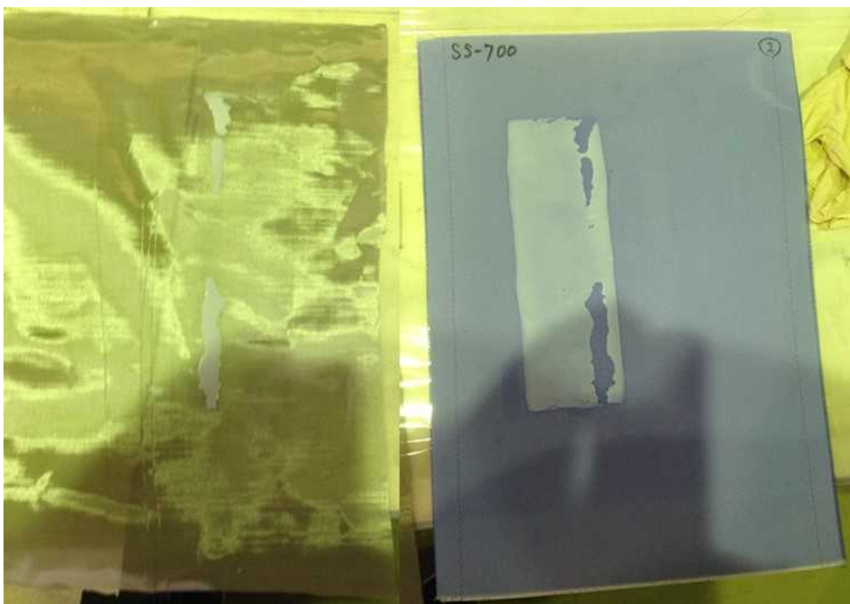
図 1-7 脱水後のワイヤー上の CNF
