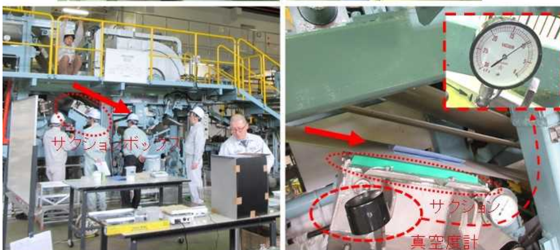
図 1-6 CNF 展開ワイヤーの作製（上）及びサクションボックスでの脱水試験（下）
