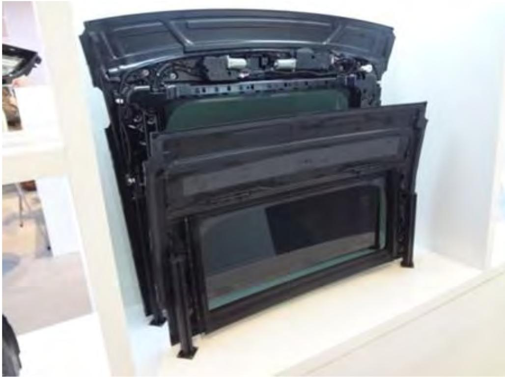
図 4.3.4 樹脂製バックドアパネル
