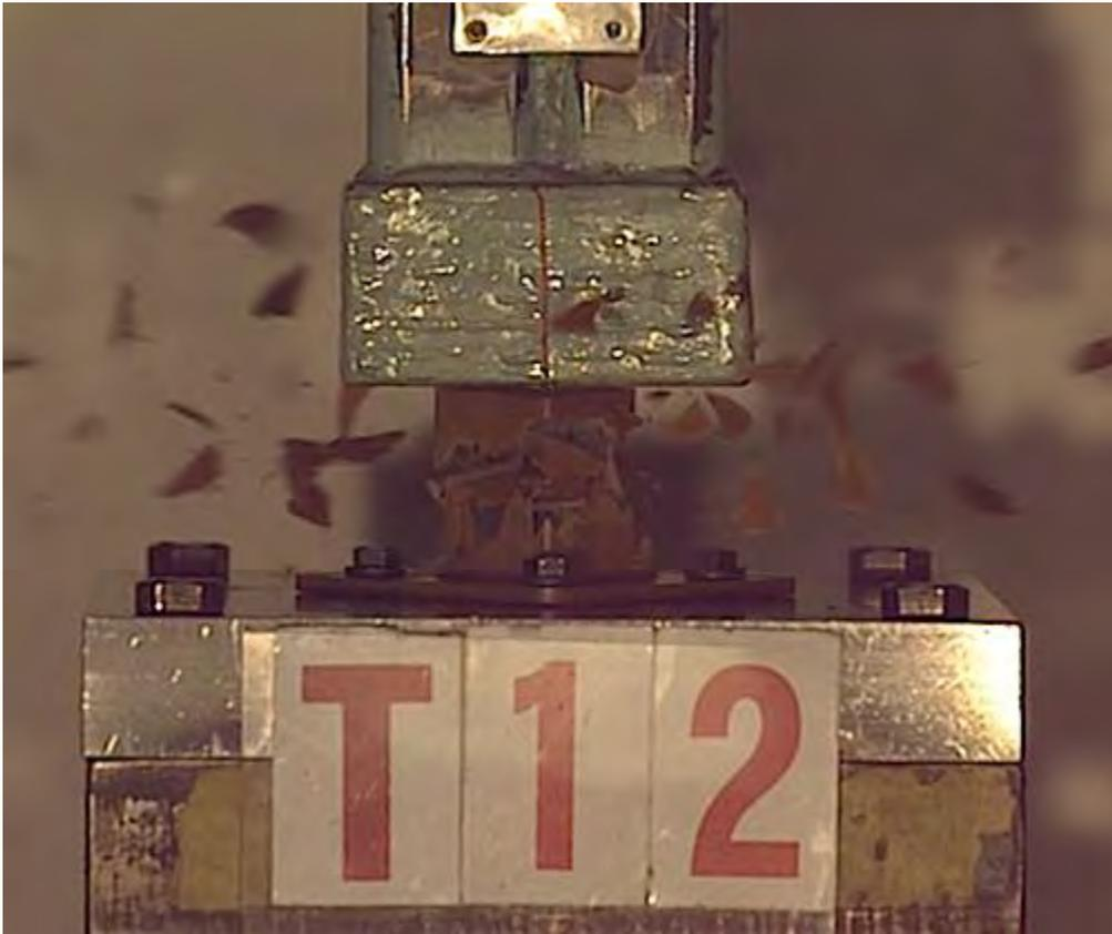
图 1.2.1.2.6 PP-CNF 破壞瞬間狀態
