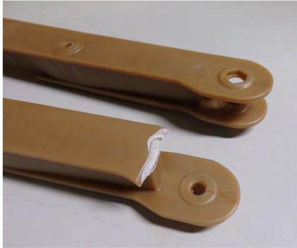
図 3.3.3 PP-CNF 成形体(型取出し時割れ)
