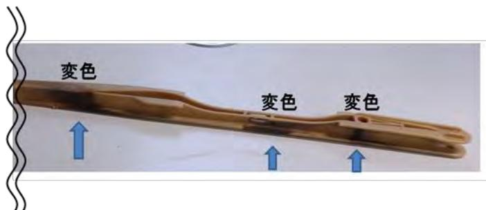
図 3.3.4 PP-CNF : 210°C成形体の変色(熱変性)
