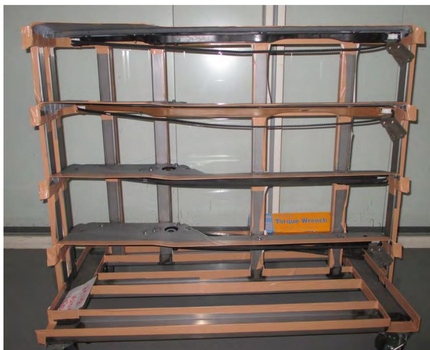
図 3.4.1 車両組付け想定治具
