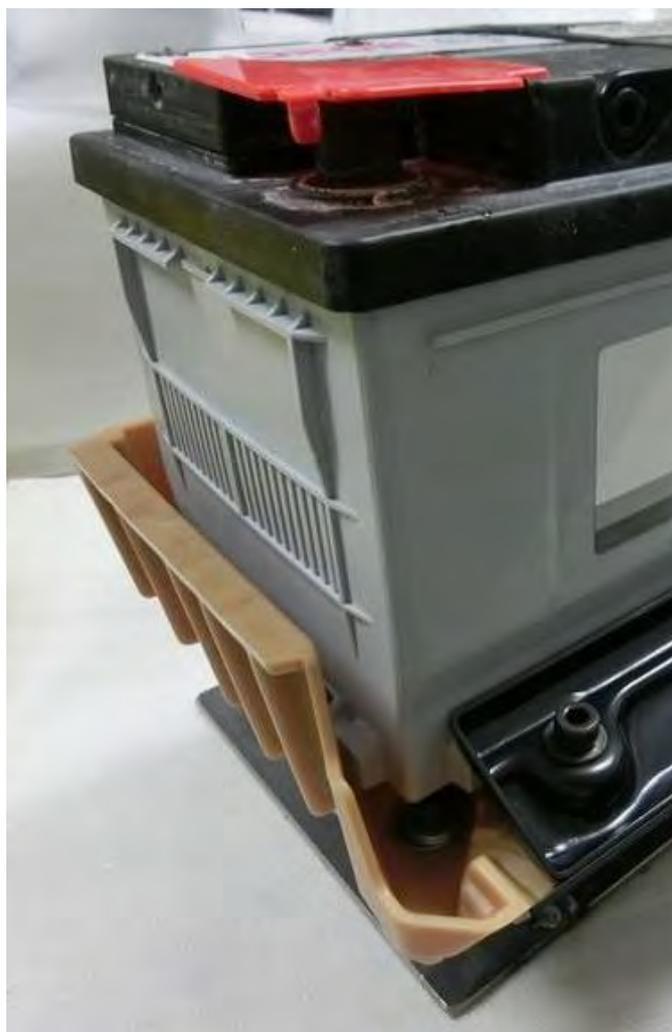
図 2.5.3 バッテリー組付け状態
