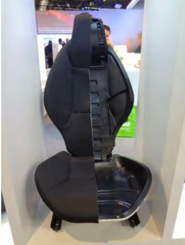
図 4.3.11 樹脂製シートフレーム
