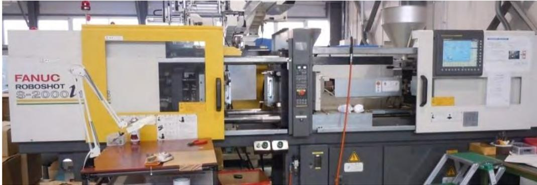
図 1.2.1.3.2 射出成形機 FANUC S-2000i 100B
