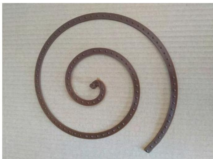
図 1.2.1.1.2 スパイラルフロー評価成形体の写真
