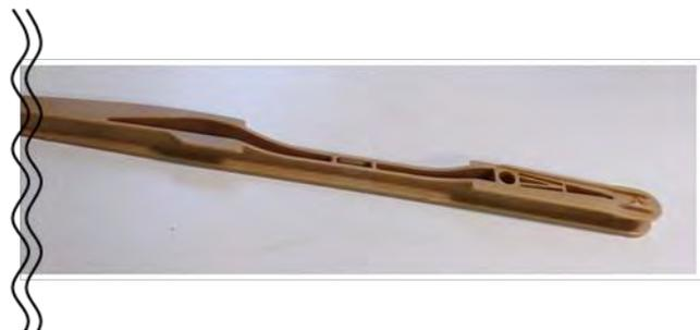
図 3.3.5 PP-CNF : 200°C成形体 : 部分的な変色なし
