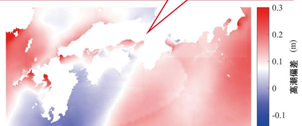
図22 不確実性を考慮した1/25年確率の高潮の将来変化予測の一例
