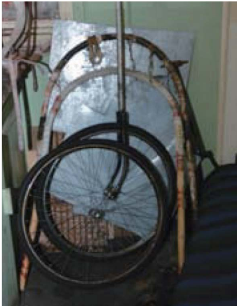
そり用の走行距離メーターを作るために使用した自転車の車輪
