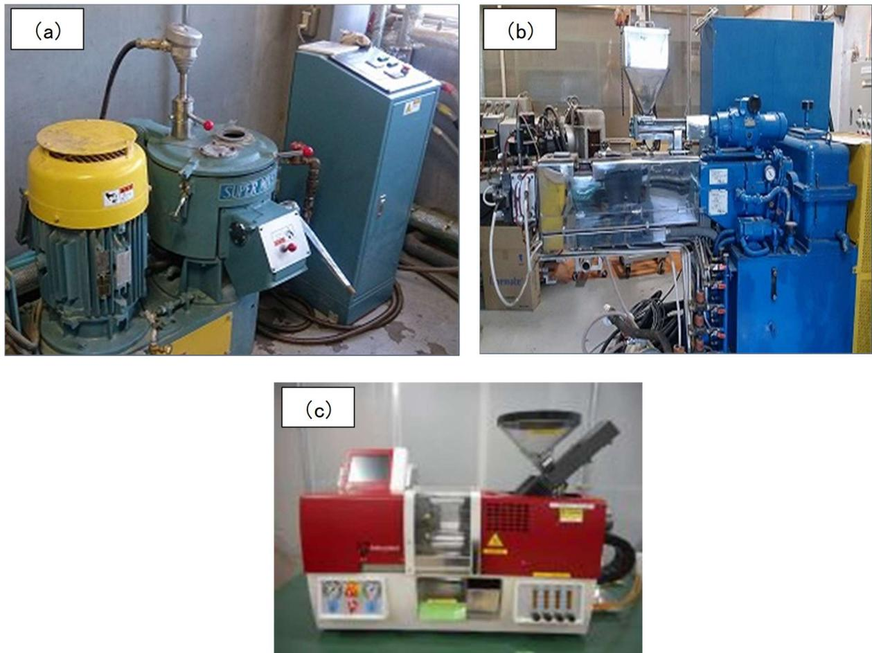
図 2-38 使用機器 (a：ヘンシェルミキサー、b：押出成形機、c：射出成形機)
