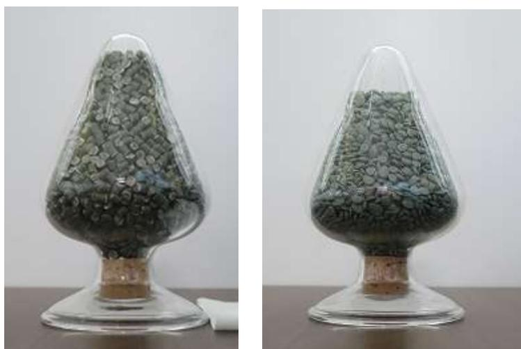
図 2-13 供試材料 (左 : Re-PP、右 : Re-PE)
