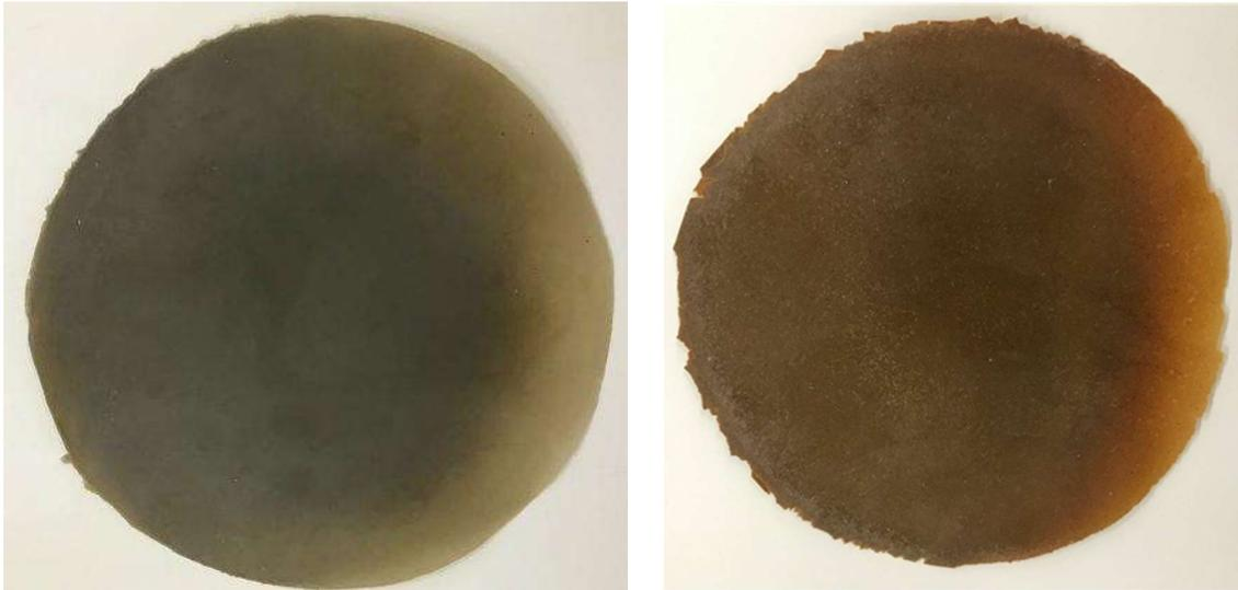
図 2-47 フィラー分散確認シート (左 : TMB、右 : WMB)
