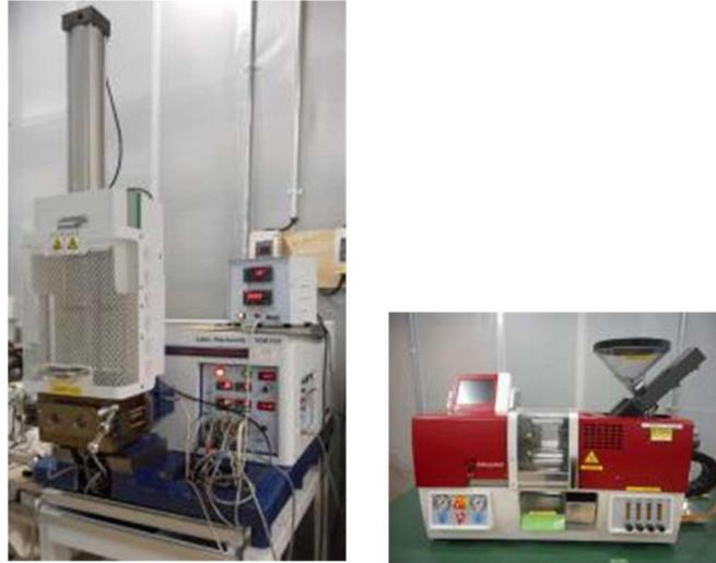
図 2-25 成形に用いたラボ設備（左：ラボプラストミル、右：射出成形機）
