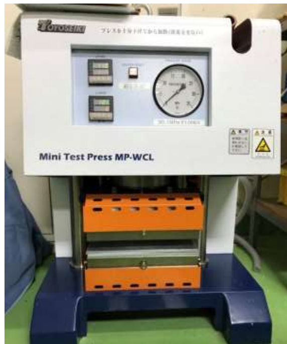
図 56 ラボスケールホットプレスマシン
