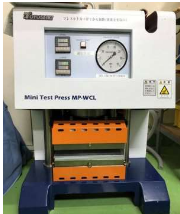
図 182 ラボスケールホットプレスマシン
