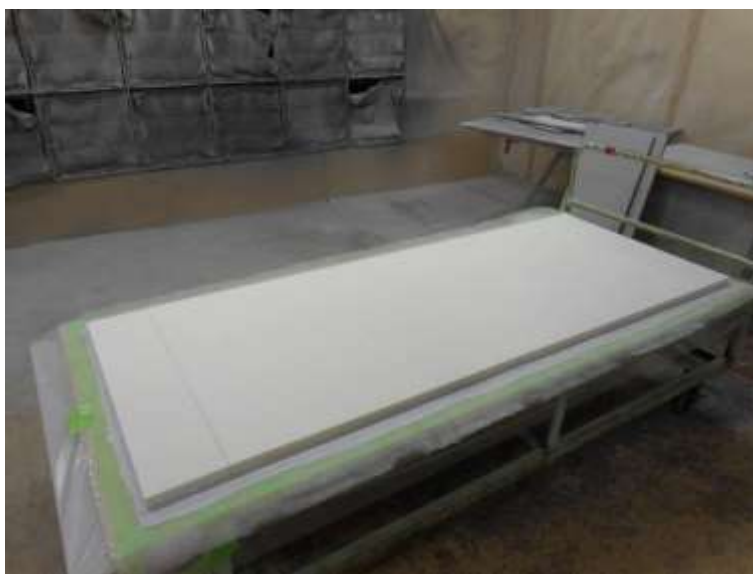
図 170 硬質発泡ウレタンの一体化
