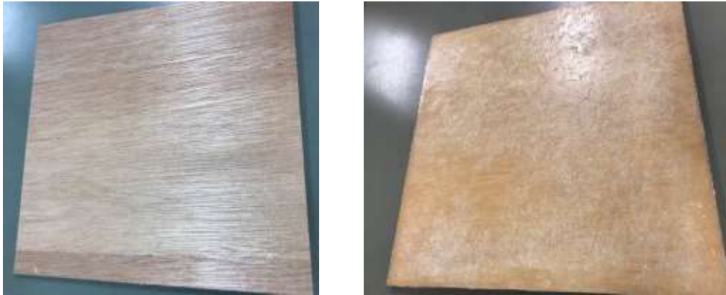
(a) (b) 図 57 試作した高剛性化粧合板 (a) 使用した合板 (b) 高剛性化粧合板
