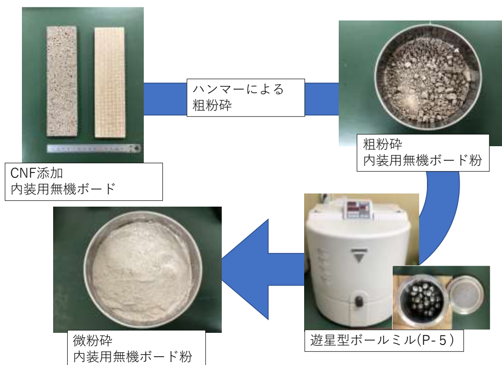
図 228 内装無機ボードの粉碎手順
