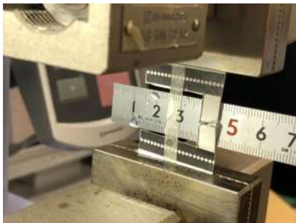
図 63 引張試験時の乾燥防止の様子
