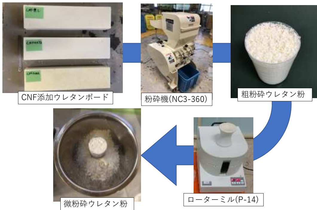
図 219 ウレタンボードの粉碎工程
