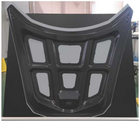
図 4.4-4 CFRP と接着し下地塗装後(裏面)
