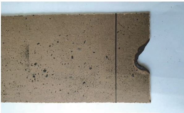
図 4.5-4 燃焼性試験後の状態
