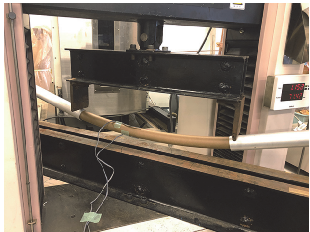
図 4.2-1 CNF パイプの 4 点曲げ試験
