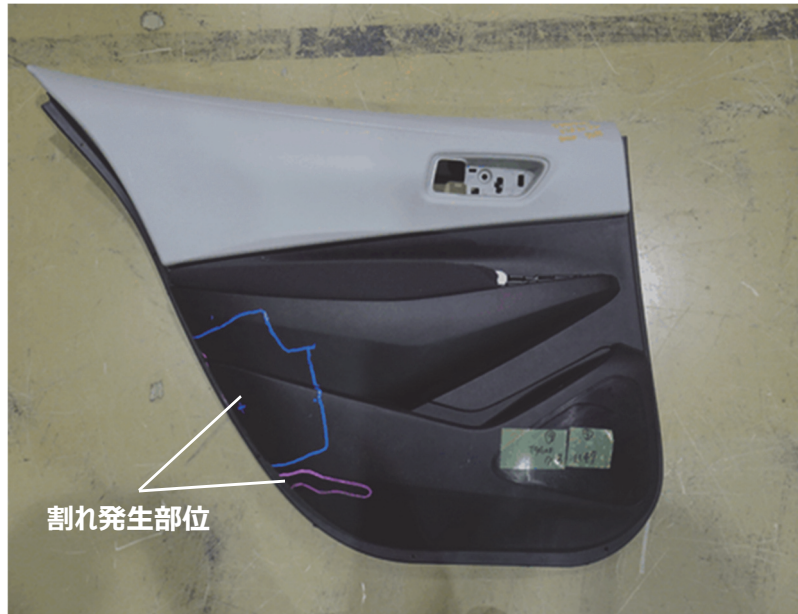
図 2.8-4 改良材でのドアトリム単体での耐衝撃試験後サンプル
