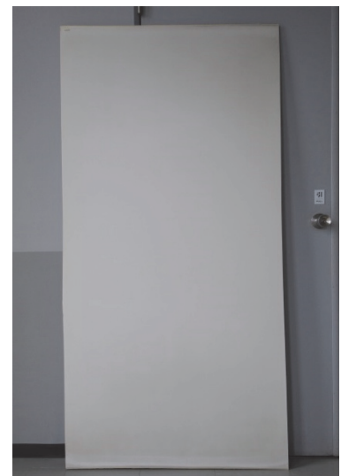
図 4.3-3 910×1820 mm の CNF ハニカムサンドイッチ材
