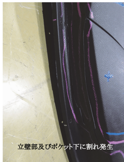
図 2.8-5 改良材でのドアトリム単体での耐衝撃試験後サンプル(割れ部位拡大)
