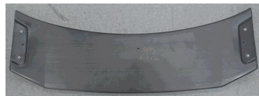
図 2.4-5 リアスポイラー車輛地面側(最終)
