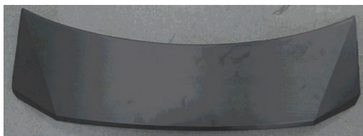
図 2.4-4 リアスポイラー車輛天面側(最終)
