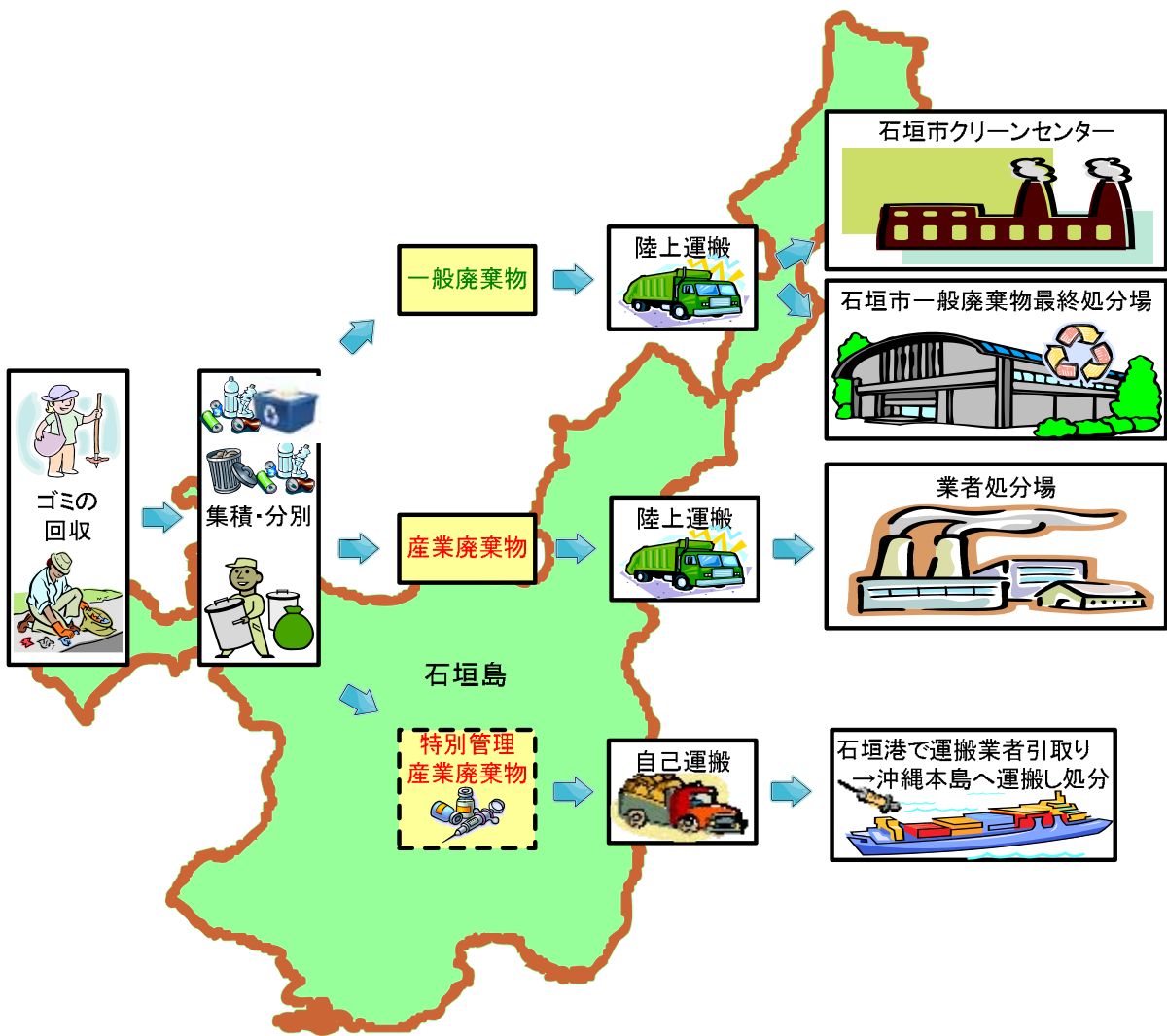
図 2.4-2 漂着ゴミの回収・運搬・処分方法のまとめ
