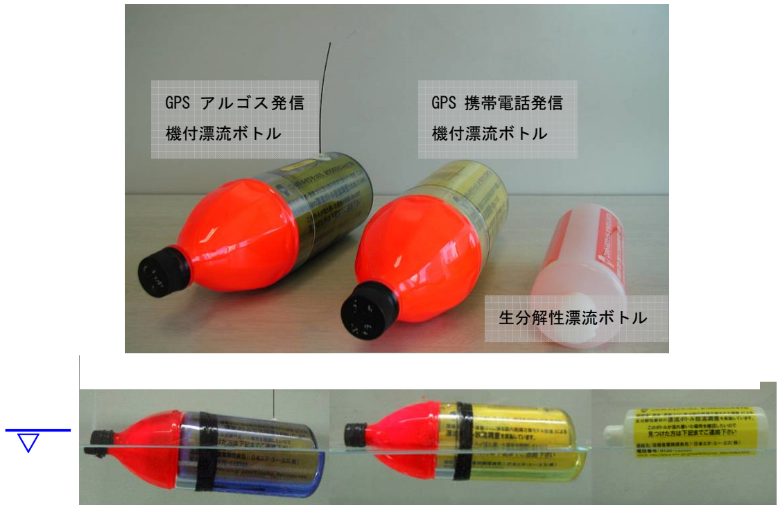
図 5.1-2 各漂流ボトルの外観と海水中での沈下状況（塩分濃度 32.5 の海水にて撮影）
