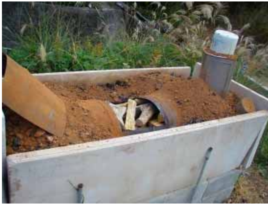
図5 炭材の窯への詰め込み
