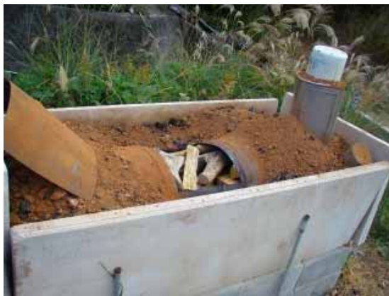
図5 炭材の窯への詰め込み
