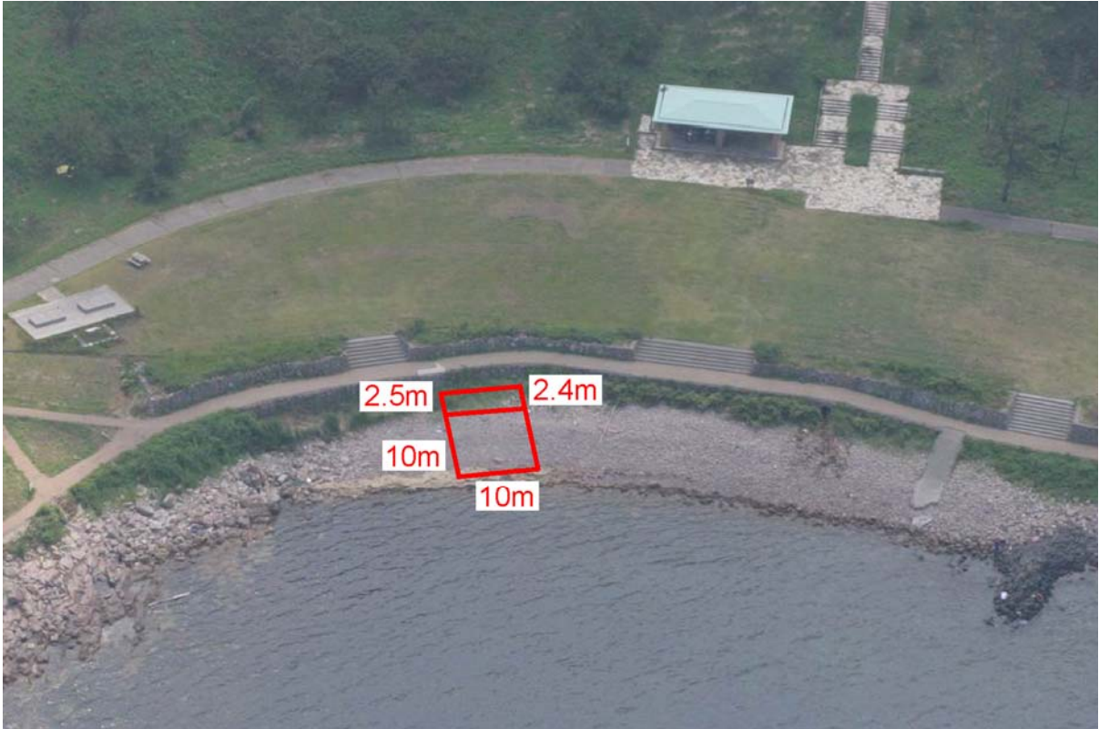
図 3.1-5(3) 共通調査枠の設置状況(地点3:二の浜)
