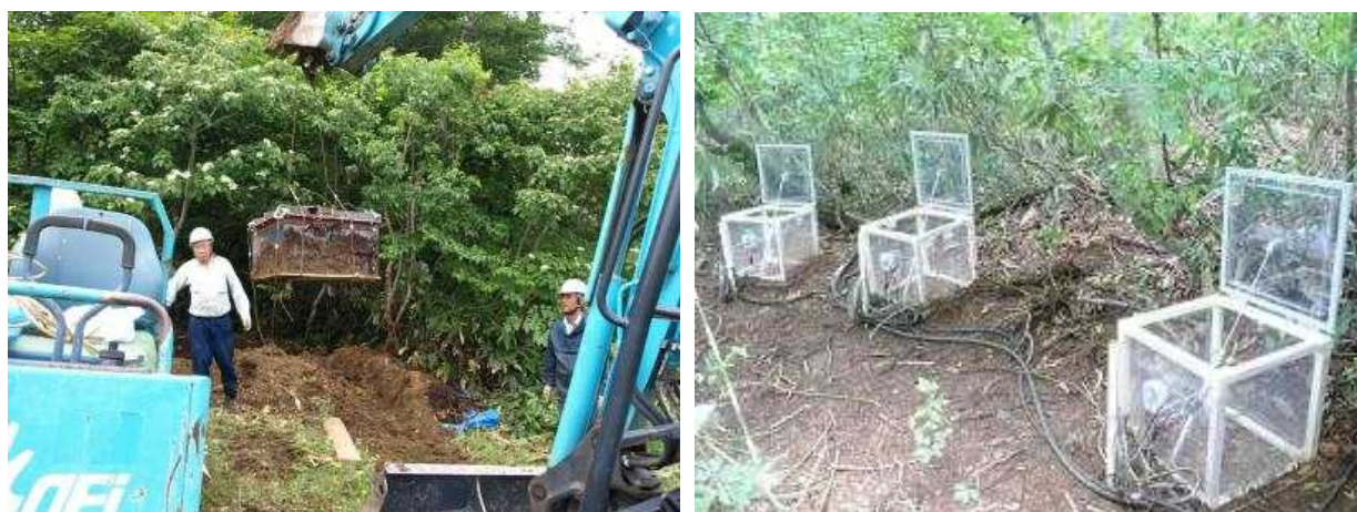
図 9. 重機を用いて大型土壌の移植による自然的な昇温実験の様子。
