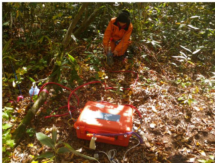
図 44. 苗場山における携帯型土壌呼吸測定システムを用いた測定の様子。
