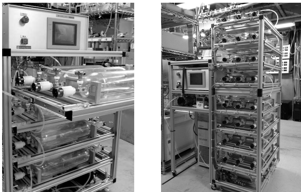
写真1. 波照間ステーションに設置したイベントサンプリングシステム。左はフラスコ12本仕様(2010年2月～2012年5月)、右はフラスコ24本仕様(2012年11月～現在)。
