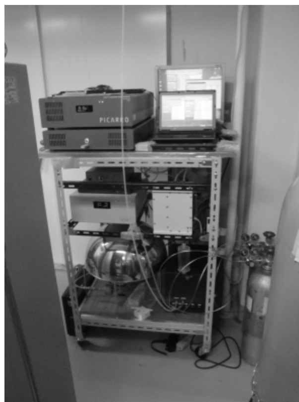
図15. Rn観測装置外観（ラック内） ラック棚上、左の分析計は、CO 2 /CH 4 分析計
