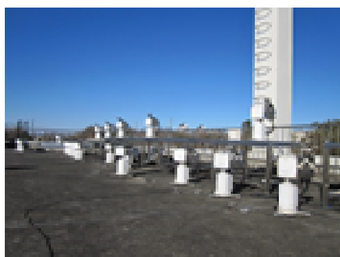
図2 2013年12月から2014年1月に気象研究所放射観測棟で実施したスカイラジオメータの比較検定観測。
