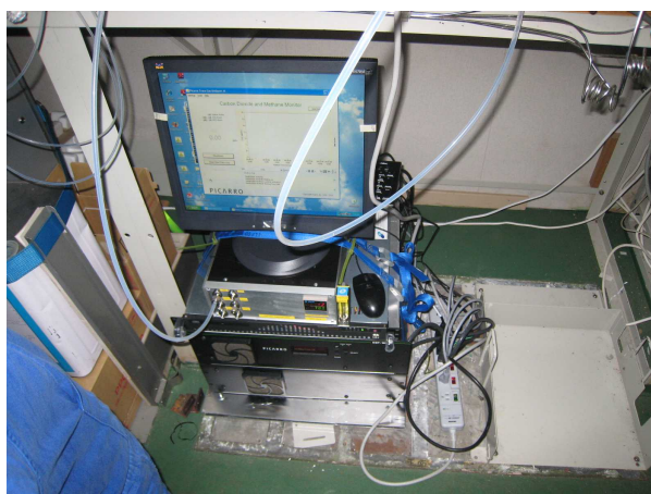
図 6 船舶観測室に設置したキャビティリングダウン式分光計（右）とガスインジェクションユニット（左）
