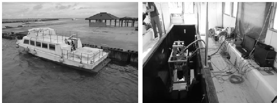
船舶ライダー観測に用いた竹富島グラスボート（左）と、イメージング蛍光ライダー装置搭載の様子（右）
