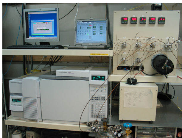
写真1. 落石岬の観測ステーションに設置したハロカーボン測定システム
