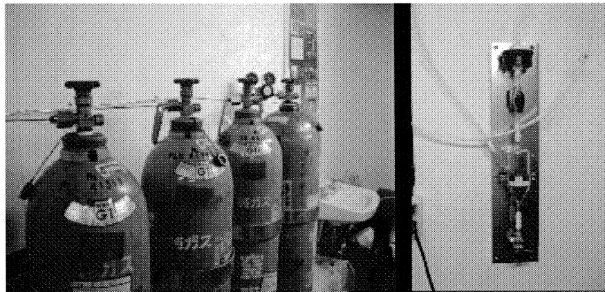
図3 (左) 標準ガス(後方1本)とパージガス(手前3本), (右) サンプルライン中に設けられたフィルター
