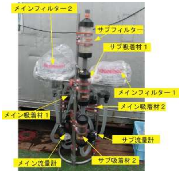
図4 現場型超大容量海水濾過装置
