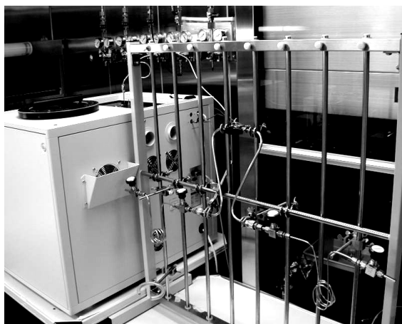
図1 元素分析計(左奥)と二酸化炭素捕集トラップ(手前)、2つのトラップを交互に切り替えて使用する
