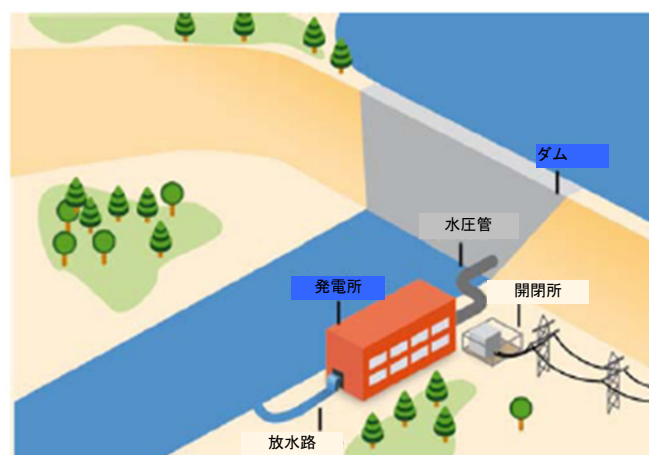
図 5.6: 典型的な貯水池付きの水力発電プラント
