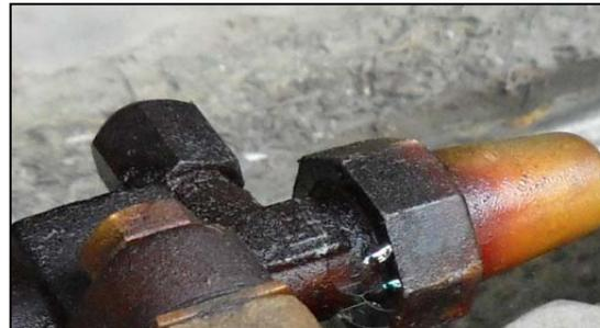
フレア継手部の劣化
