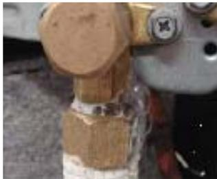
ピンポイントの漏えい検知に適している。漏えい可能性のある箇所を発泡液を塗布し、吹き出すフロンを検知。
