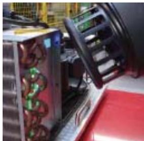
配管内に蛍光剤を注入し、漏れ箇所から漏れ出した蛍光剤を紫外線等のランプを用いて漏れ箇所を特定。
