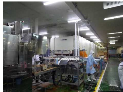
製造ライン (急速硬化室) 写真中央の白色の設備において商品の凍結を行っている。
