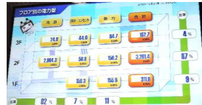
<BEMS画面：電力使用状況を電光掲示板で常に掲示>
