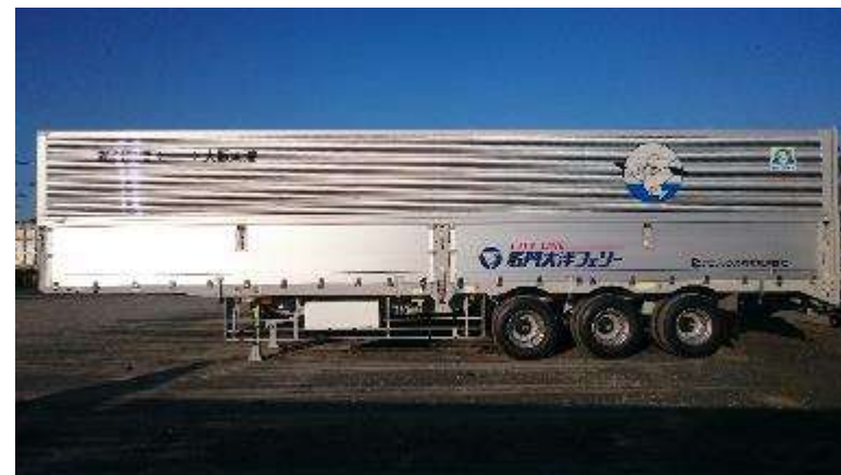
セミトレーラ (アルミウイング架装3軸緩和シャーシ)
