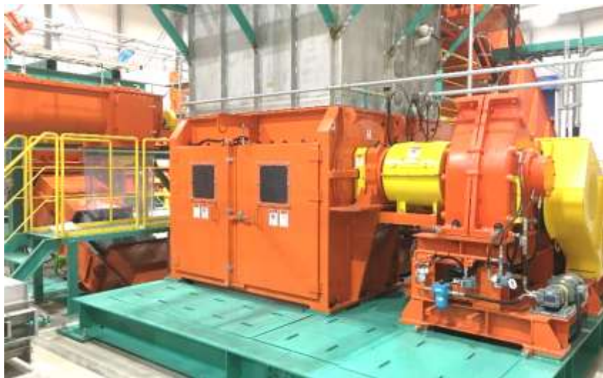
難破砕モードのある破砕機 (システム図の破砕機2)
