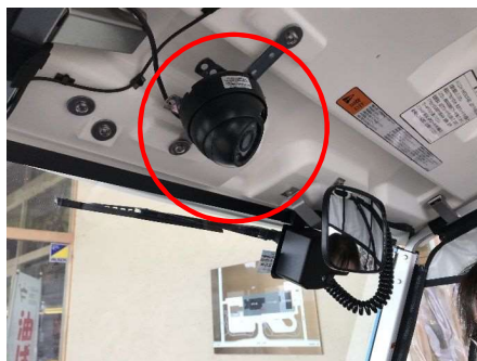
写真①：運転席上部に取り付けたカメラ
