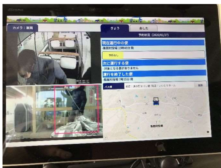
写真④：グリスロ運転席用画面 画面左上：車内監視用カメラの映像 画面左下：車外監視用カメラの映像 画面右上：予約状況の一覧 画面右下：車両位置を表示するマップ
