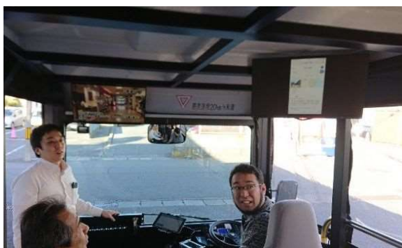
図 22 IoT システム(車内サイネージ)
