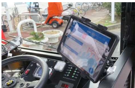
図 21 IoT システム(ドライバー端末)
