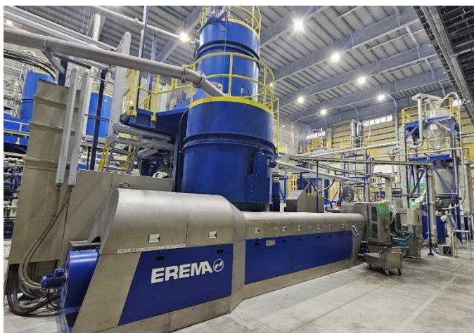
②メカニカルリサイクル設備 [処理能力 1,450kg/h]
