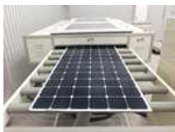
太陽光発電設備リサイクル設備
