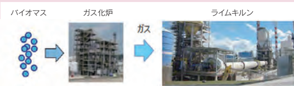
事業イメージ図：既存重油燃料のバイオマスガスへの転換
