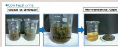
新開発の凝集剤による固液分離
