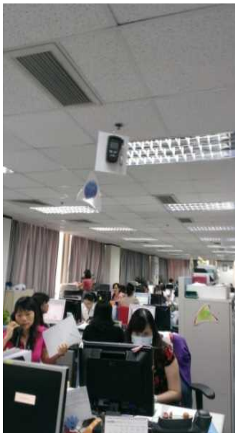
図 テナント階の温湿度測定
