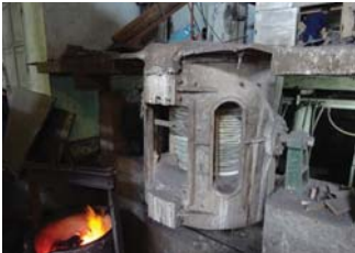
電気炉(中国製・1.5 ton)
